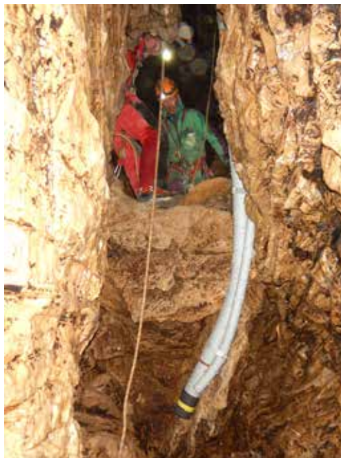
L'istallazione degli strumenti di monitoraggio presso il sifone principale della Grotta di Fiumelatte.
